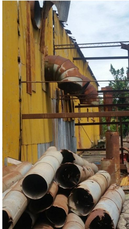
Figura 3 y 4: Horno y tubos se succión para algodón en desmotadora Oro Blanco, La Gomera, Escuintla
